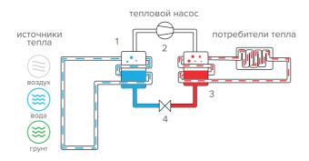
Тепловые насосы используют теплоту окружающей среды (например, грунта, воздуха или грунтовых вод) для обогрева и охлаждения помещений и нагрева воды.
